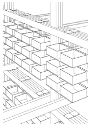
Illustration: Axonométrie de la structure métallique supportant les vivariums, fixé sur la structure bois Source: C. Lopes
