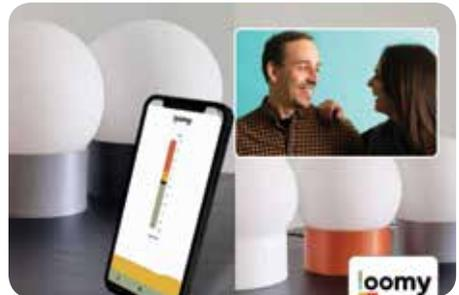
Le prototype développé par **Christophe et Kimber (FL)**, **Loomy**, propose à tout-e consommateur-riche un **aperçu exploitable de sa consommation d'énergie**. Chaque couleur émise par cette lampe intelligente indique un niveau de consommation d'énergie différent, permettant ainsi de **réduire cette dernière** et de mieux la répartir.
