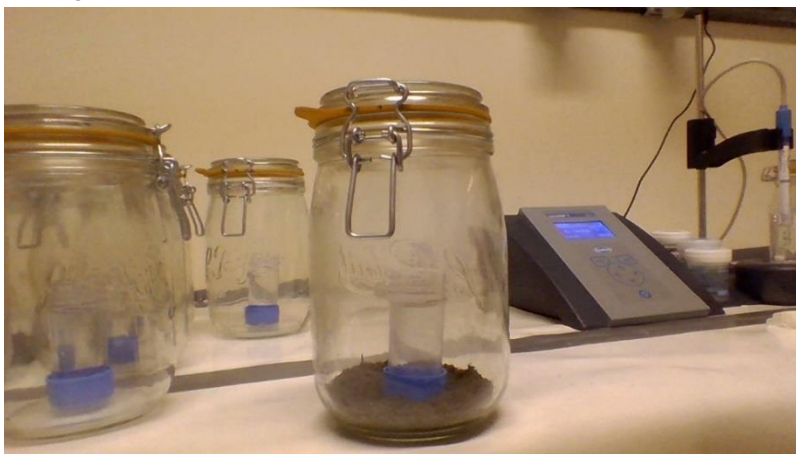
Figure 11: Bocal hermétique contenant 40 grammes d'échantillon de sol ainsi qu'une solution de NaOH.
