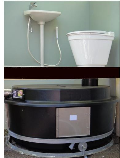
FIGURE 6.12 – Composteur rotatif manufacturé commercialisé par Ekolet. Le composteur pivote sur son axe quand une pile de matière suffisante s'est accumulée sous le tuyau de chute. (Source : Ekolet.)
