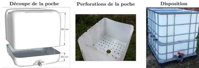
**FIGURE 6.26** – Modification d'une cuve IBC en composteur.
