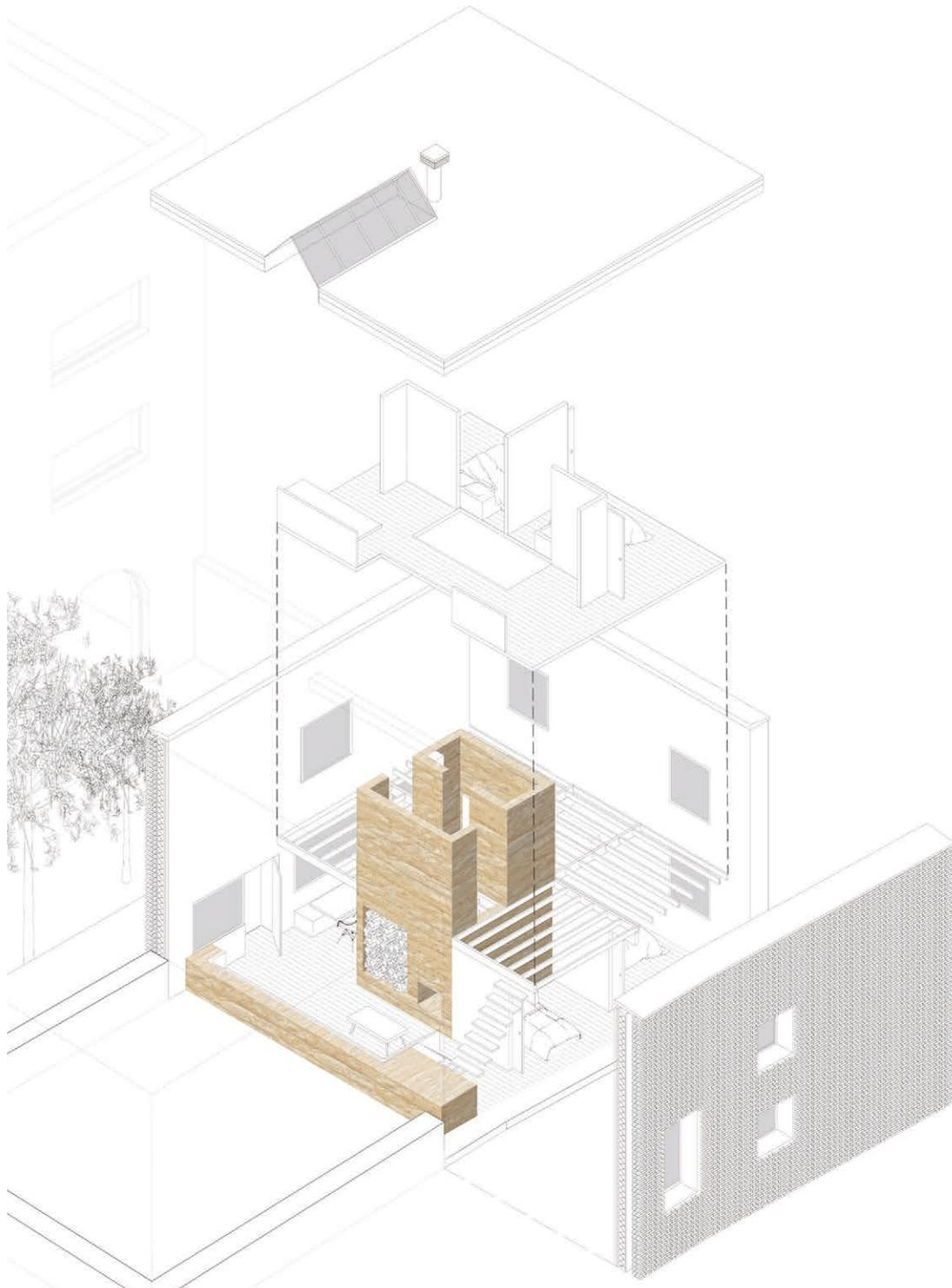
Axonométrie d'un logement type, un noyau comme structure spatiale
