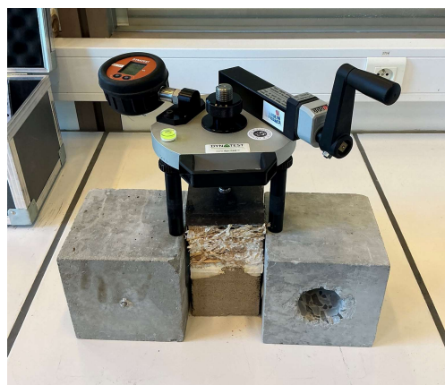
Figure 53 - Mise en place du Dynatest
