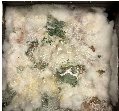
Figure 57 - Contamination par Trichoderma de l'échantillon BRI - PL - PA - 2
