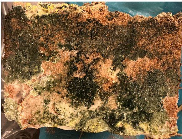
Figure 56 - Contamination par Trichoderma de l'échantillon COM - GL - EN - L - 2
