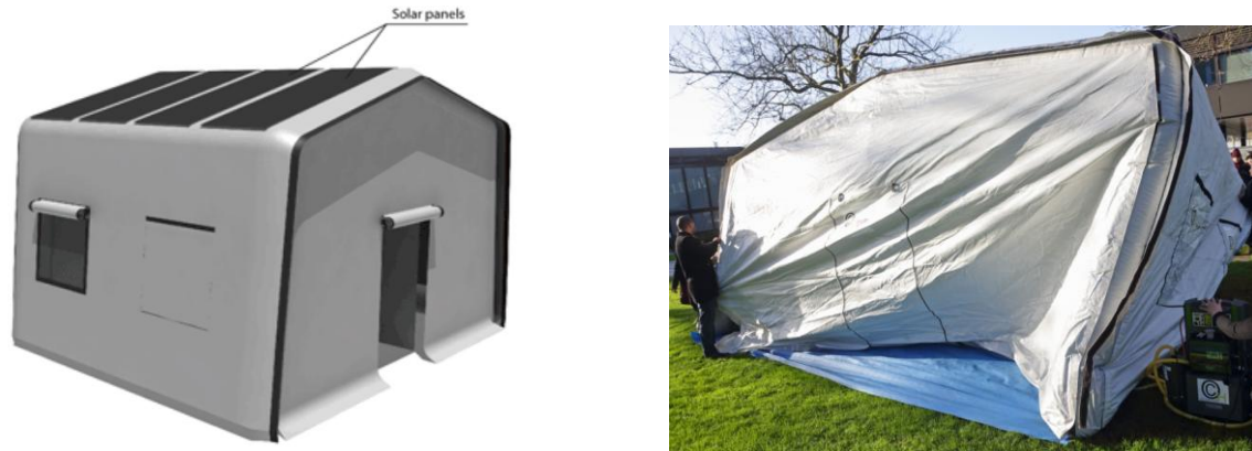
Figure 86: a) Visualisation du module pneumatique photovoltaïque. ; b) Module taille réelle en cours de déploiement
