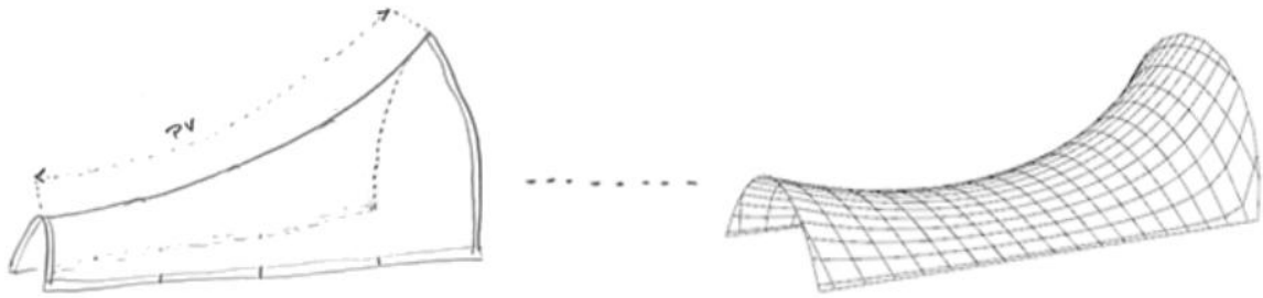
Figure 107 : Schéma traduit en modélisation 3D expérimentale d'une membrane tendue (source : auteur).
