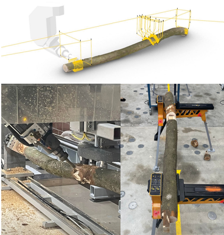
Fig.31- a) modèle 3d issu du scan et visualisation du parcours de l'outil b) fraisage du mi-bois c) résultat de la découpe industrielle
