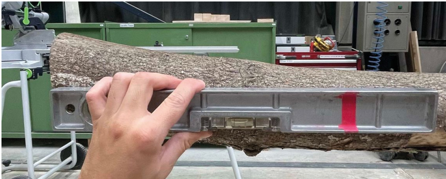
Fig.33- Positionnement de la pièce à tailler selon le plan de référence, Septembre 2024
