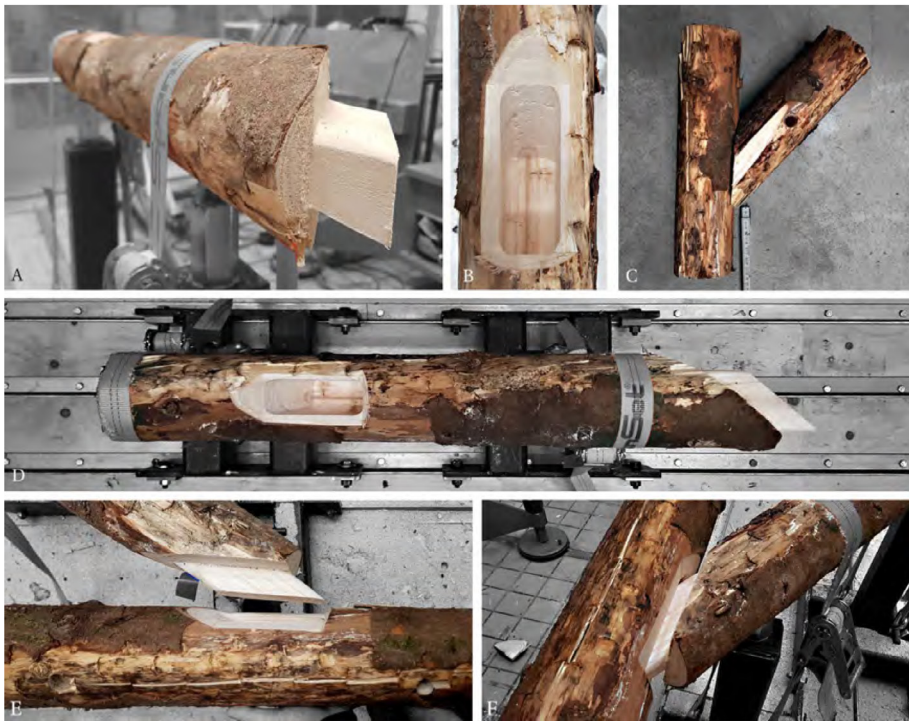
Fig.28- Test du Joinery Solver sur un assemblage tenon-mortaise en bois rond
