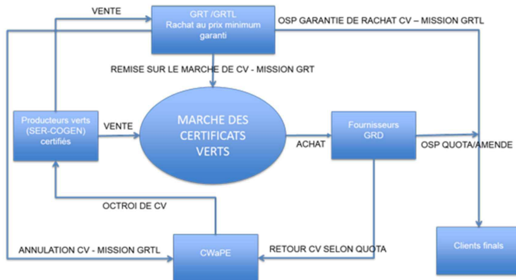
Figure 19 – Principe de fonctionnement du marché des certificats verts en Région wallonne. (Source: CWaPE 2017)
