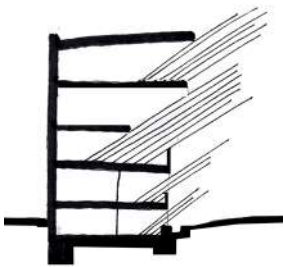
30. Coupe schématique montrant l'entrée de la lumière dans les cuisines. (fait par moi-même)
