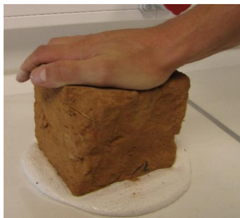
Figure 165 : Application d'une surface d'enduit.
