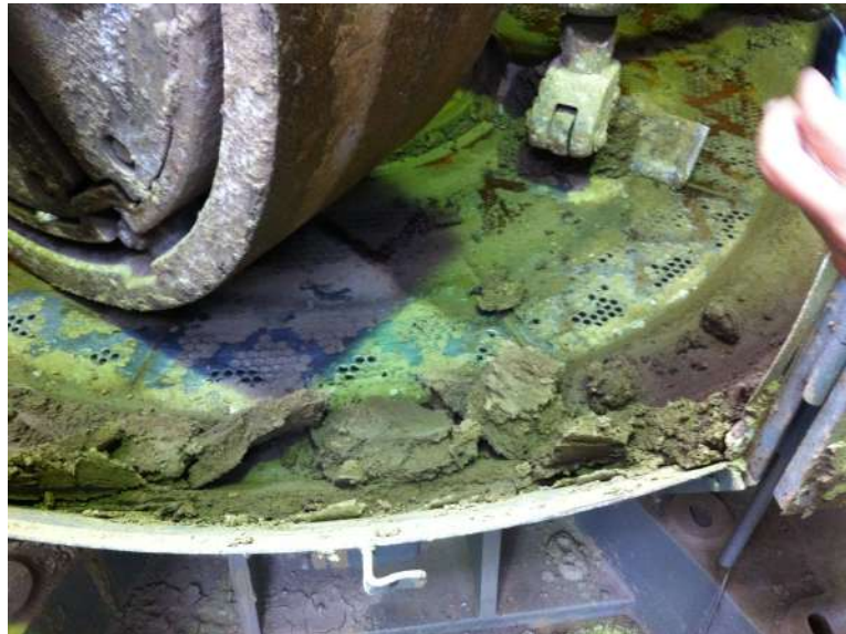
FIGURE 12.6 – Broyage de la terre par les meules
