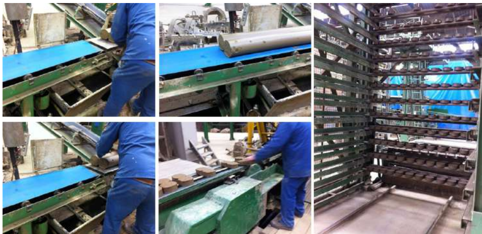
FIGURE 12.18 – Production des galets d'argile utilisé par Mobic dans le système ArgiMob
