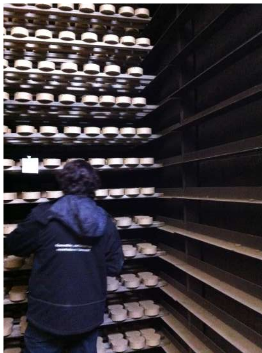
FIGURE 12.10 – Lattes métalliques sur lesquelles sont posés des galets d'argile, dans un séchoir
