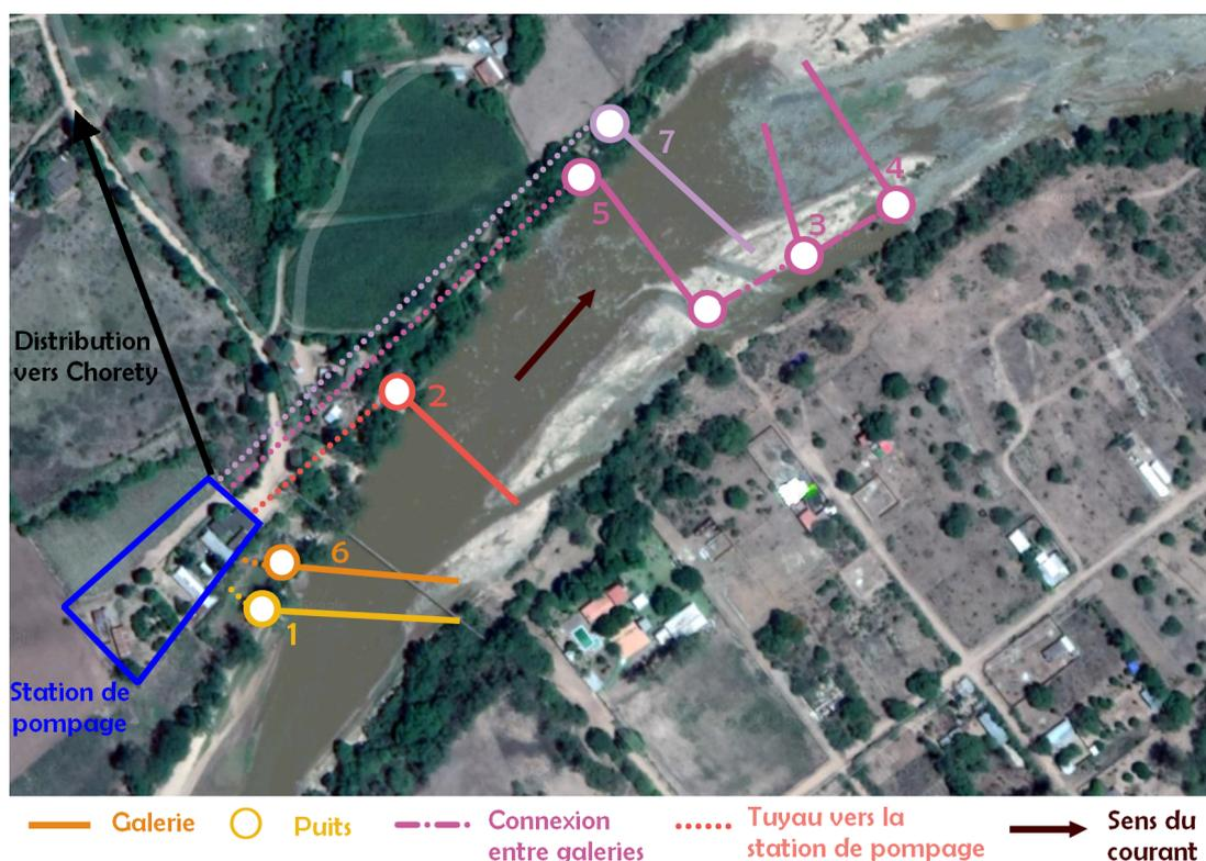
Figure 4.3 – Disposition des galeries le long de la rivière Parapeti à Chorety (Camiri) – Source : [32]
