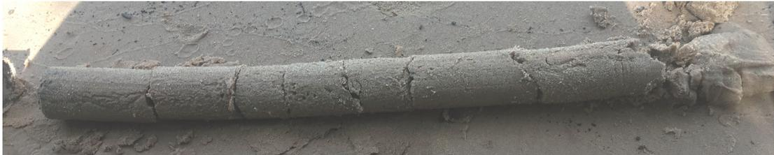
(a) La carotte, une fois récoltée dans la rivière, est retirée de la carotteuse et déposée sur la berge.
