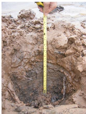
**Figure 4.11 – Photo du profil vertical de sable sur les berges du Parapeti. Deux parties sont visibles : la partie supérieure est supposée être la zone colmatée, la partie inférieure la zone de lit. – Source : [33]**
