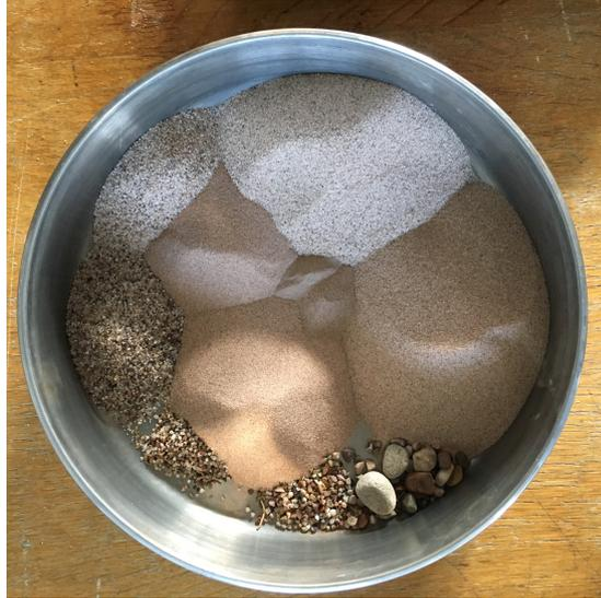
**Figure 4.7 – Échantillon de sable divisé par tamisage en 11 paquet différents en fonction de la taille des particules. Chaque paquet est pesé de manière à faire une distribution en masse de la taille des particules dans l'échantillon analysé.**
