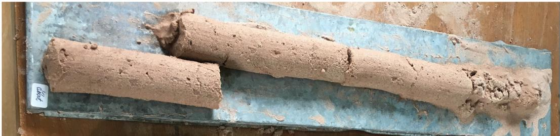
(b) Elle est ensuite déplacée sur un support plat où la carotte peut sécher avant d'être coupée en morceaux et rangée dans des sachets.
